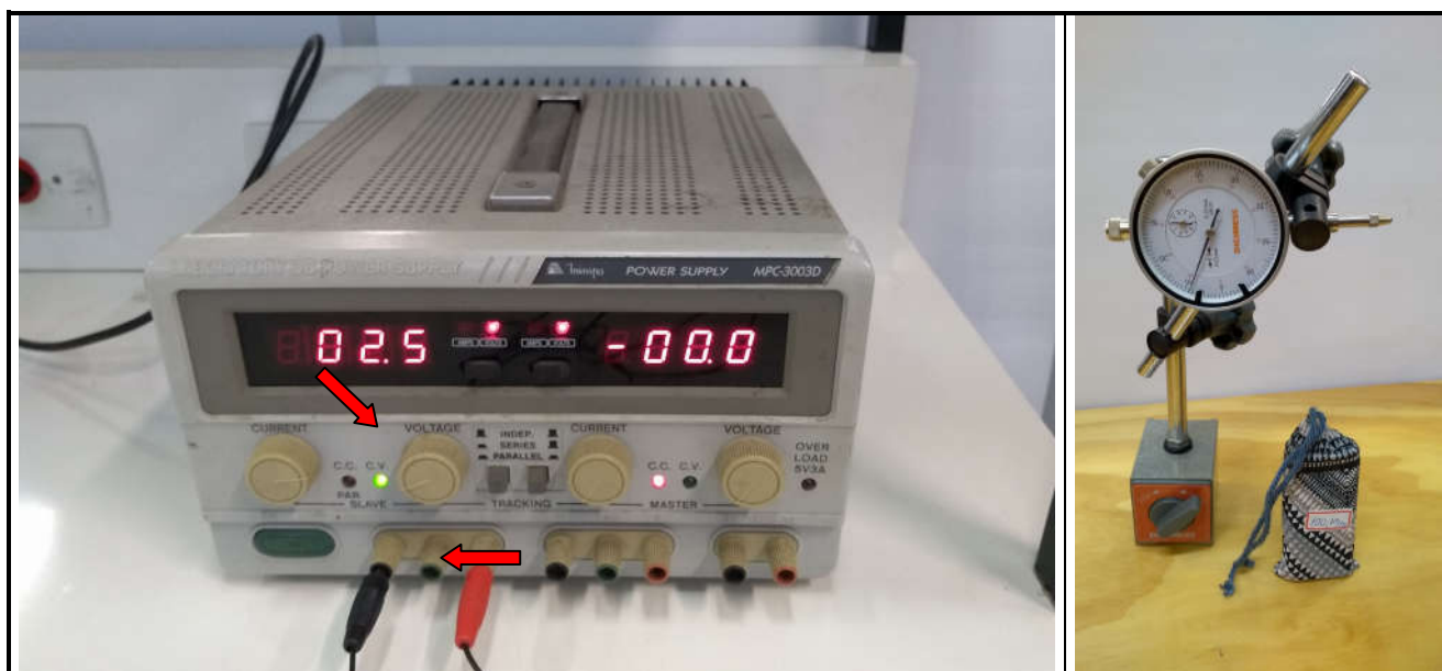
Figura 3 – Montagem da Fonte do Excitador (conectar os fios e regular a tensão)
