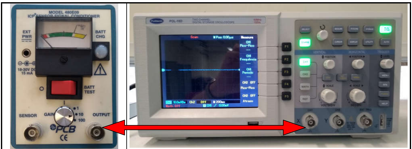
Figura 5 – Alimentação do Acelerômetro e Osciloscópio para Medição
