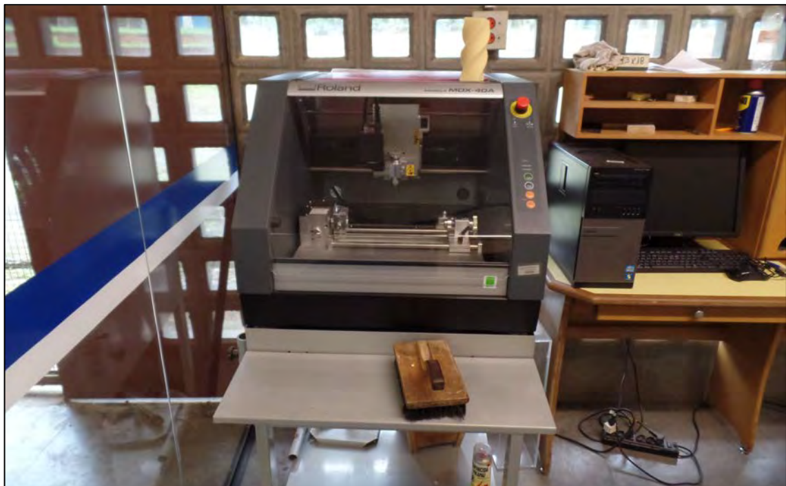
Figura 52 – Fresa CNC quatro eixos FabLab SP FAU USP (Universidade de São Paulo – São Paulo – Brasil)
