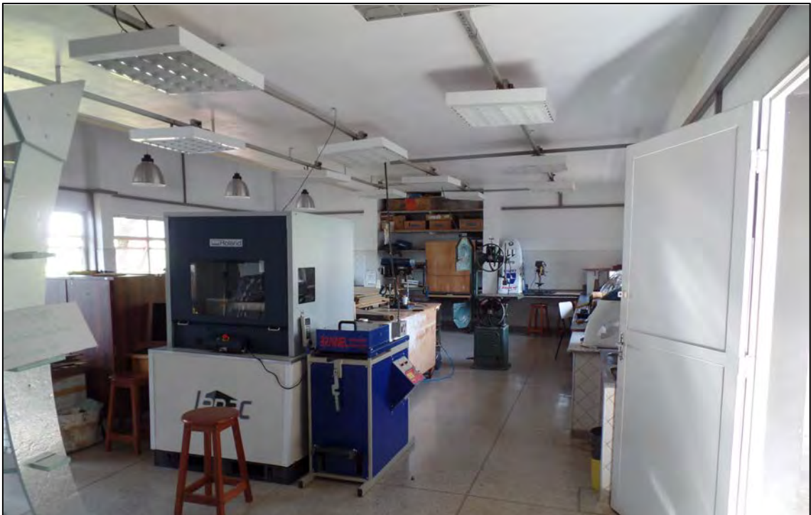
Figura 55 - LAPAC UNICAMP - Térreo do Laboratório - Equipamentos CNC com quatro eixos e vacuum forming (Universidade Estadual de Campinas - São Paulo - Brasil)
