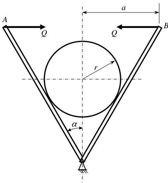
barras iguais, de peso desprezível, submetidas a forças horizontais de mesma magnitude aplicadas em  $A$  e em  $B$ . O coeficiente de atrito entre as barras e o disco é  $\mu$ . Sendo conhecidos o ângulo  $\alpha$  e a distância  $a$ , pede-se:
