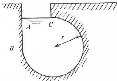
Seja  $\rho g$  o peso específico do líquido e  $\vec{F}$  a resultante das forças de pressão do líquido sobre a superfície curva da canalização. Pede-se, em função de  $\rho g$ ,  $r$  e  $L$ :
