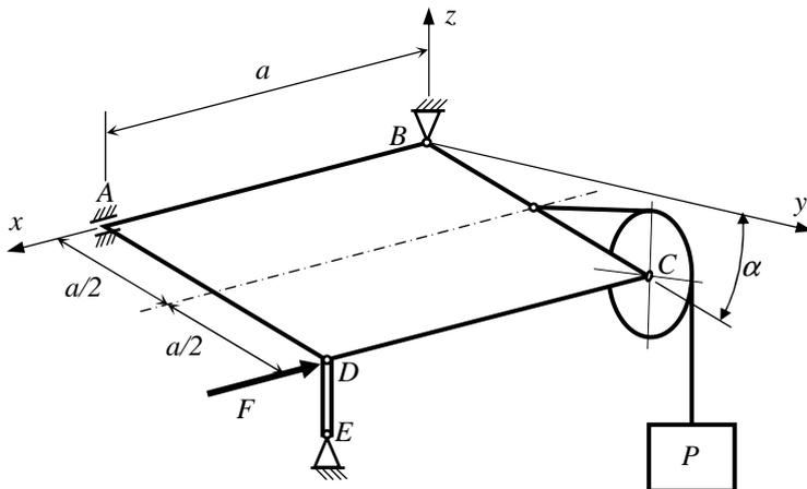
26) A placa quadrada  $ABCD$ , homogênea de peso  $Q$ , está presa em  $A$  por um anel pequeno e articulado em  $B$  e  $D$ . A barra  $DE$  está articulada em  $E$ . O raio da polia é  $r$ . Sendo aplicada ao sistema a força  $F$ , como mostrado na figura, pede-se determinar as forças de reação em  $A$ ,  $B$  e  $D$ .
