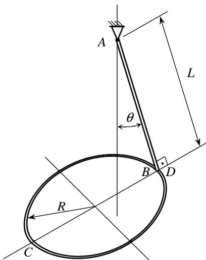
20) O arame da figura tem peso específico  $\gamma$  e área transversal  $S$ . O trecho reto  $AB$  tem comprimento  $L$  e forma um ângulo reto com o plano que contém o trecho  $BCD$ , de raio  $R$ . Pede-se determinar o ângulo  $\theta$  que o trecho  $AB$  forma com a vertical na posição de equilíbrio estático.
