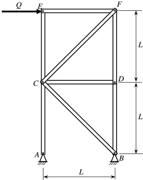
24) A treliça mostrada na figura ao lado, de peso desprezível e dimensões indicadas, está sujeita à força  $Q$  horizontal e está vinculada por articulações em  $A$  e em  $B$ . Calcule as reações externas e as forças em todas as barras, indicando se são de tração ou de compressão.
