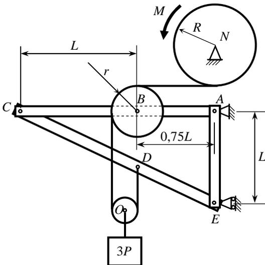
12) Um sistema de elevação de cargas é acionado por meio de um mecanismo que gira a polia de centro  $N$ , conforme indicado na figura. As barras  $ABC$ ,  $CDE$  e  $AE$ , as polias e o fio têm pesos desprezíveis. Para a situação de equilíbrio indicada, a carga  $3P$  está em repouso. Pedese:
