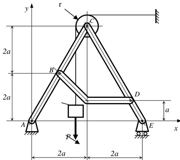
28) A estrutura ilustrada na figura ao lado é formada pelas barras  $AC$ ,  $BD$  e  $CE$ , de peso desprezível. A polia e o fio, ideais, também têm peso desprezível. O fio sustenta um bloco de peso  $P$ . Pede-se:
