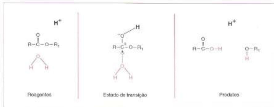
Fig. 5.5 Mecanismo da hidrólise de um éster catalisada por um ácido. A presença dos íons H^+ altera a distribuição de cargas elétricas do éster, criando um caminho de reação que necessita de energia de ativação menor do que o da reação não catalisada.
