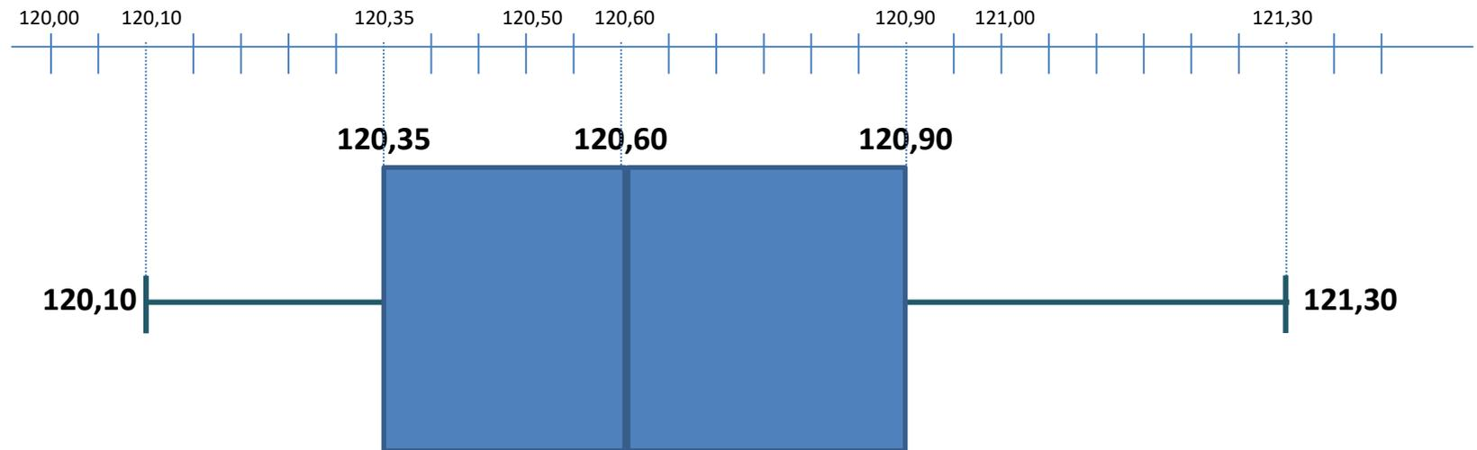
Figura: Diagrama de Caixa para os Diâmetros de Orifícios (em mm) das Nervuras do Bordo da Asa
