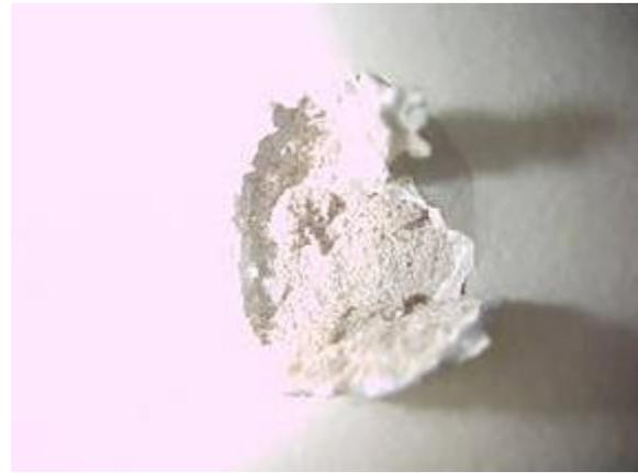
Cal utilizada sem hidratação completa ou agregado com material orgânico
