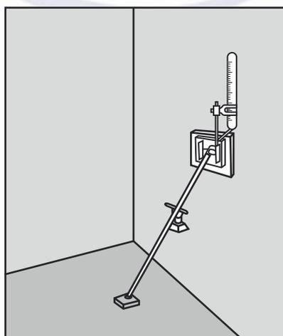
Figura D.1 – Acoplamento de câmara de ensaio à parede
