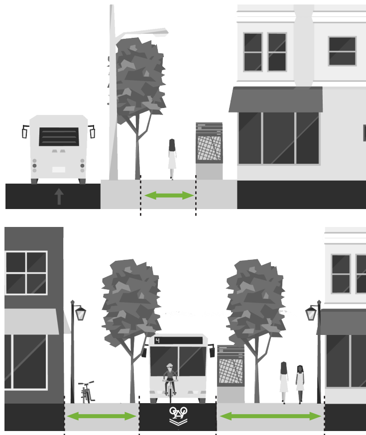
Figura (Acima): Largura útil a ser considerada em vias com calçadas segregadas e circulação de veículos motorizados.
