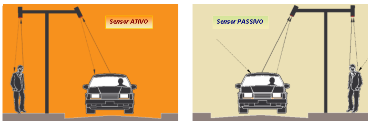
Figura 3.12: Emissão e reflexão de energia por veículos e superfície viária
