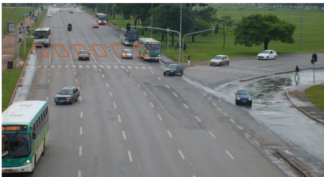
Figura 3.8: Representação de imagem de vídeo com zonas de detecção configuradas na tela do monitor
