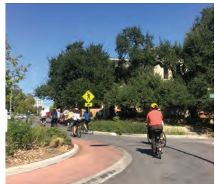
Austin, EUA. Uma guia montável em uma rotatória de bairro permite que os veículos maiores circulem pelo cruzamento quando necessário, mantendo o tráfego cotidiano tranquilo.
