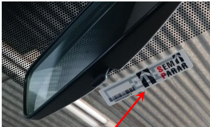
Tag de RFID no para-brisa do carro
