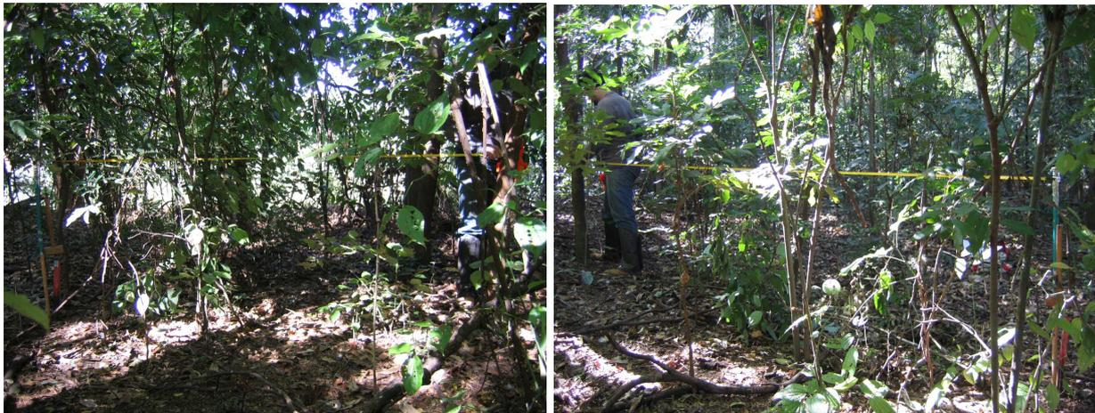
**Figura 2.** Tomada das medidas de distância em relação a dois vértices consecutivos. As figuras mostram o caminho percorrido do vértice da parcela até a árvore, a fim de se formar um triângulo.
