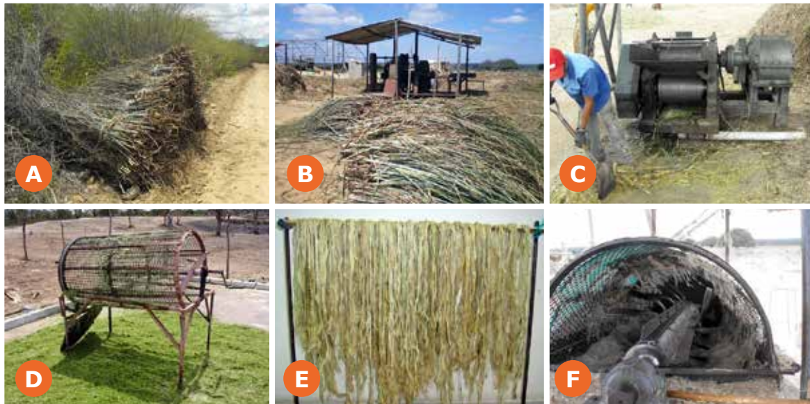
FIGURA 5 - Colheita e beneficiamento de fibras de caroá. A) Deposição dos feixes à beira da estrada; B) Plantas no local de beneficiamento; C) Máquina desfibradora da polpa; D) Peneira rotativa para separação da mucilagem; E) Fibras de caroá expostas para secagem; F) Boca do batedor de fibras. Fotos: Marconi Luiz França
