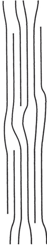
FIGURA 3.35 Regiões cristalinas nas quais as cadeias encontram-se paralelas e ordenadas, separadas por regiões amorfas.
