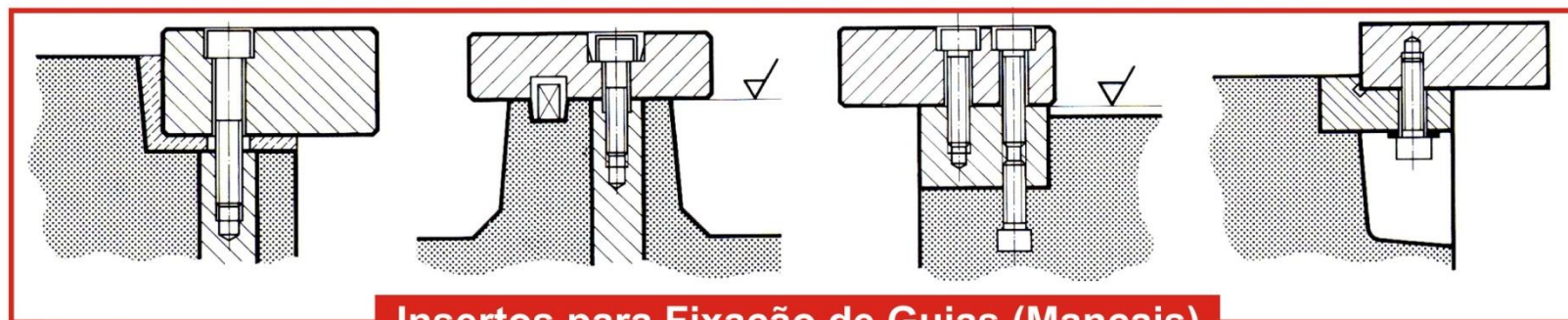
Insertos para Fixação de Guias (Mancais)
