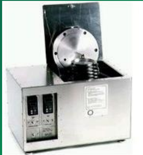
vaso pressurizado - PAV
