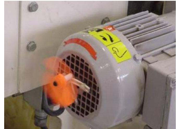
Para inspeção do funcionamento de motor
