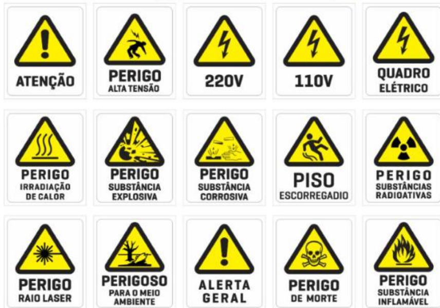
Sinalização de perigo em ambiente de trabalho
