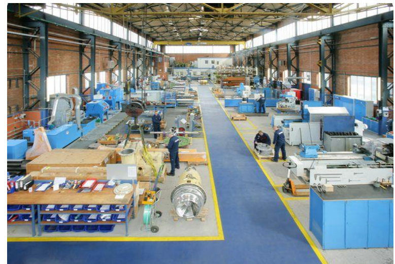
5S para delimitação de corredores, áreas de processo e locais para entrada /saída de materiais
