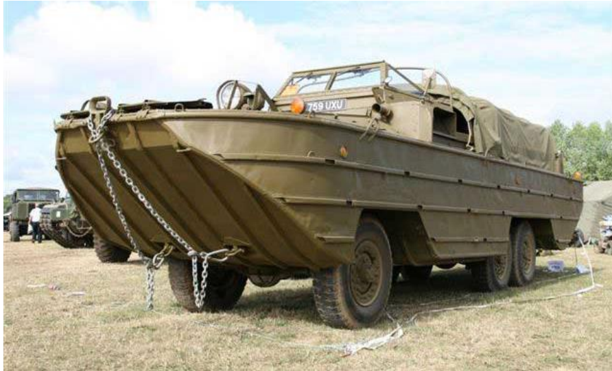
Figura 1.2.2. DUKW de General Motors. Fuente: http://www.milweb.net/features/dukw.php
