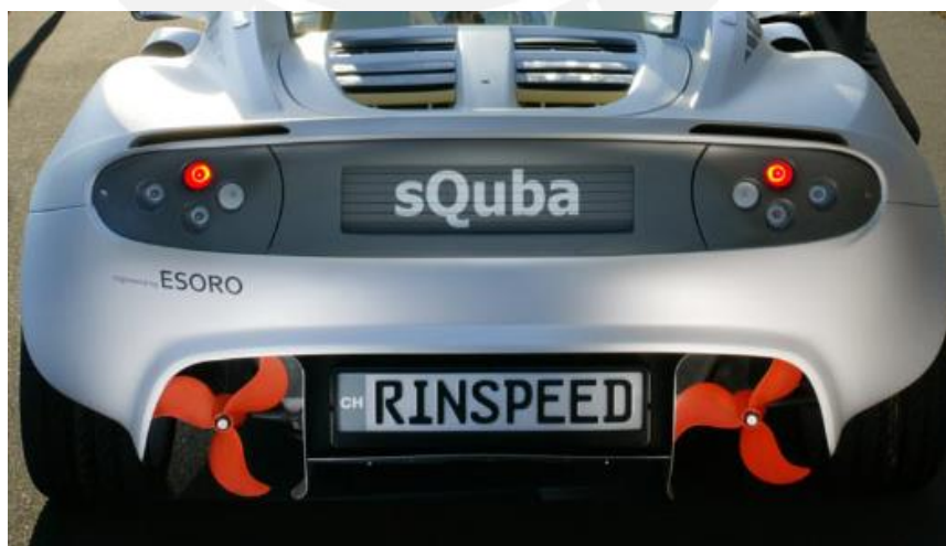
Figura 2.2.2.2. Hélices en el Rinspeed sQuba. Fuente: http://www.desktopmachine.com/framepic.php?id=12449&size=1024
