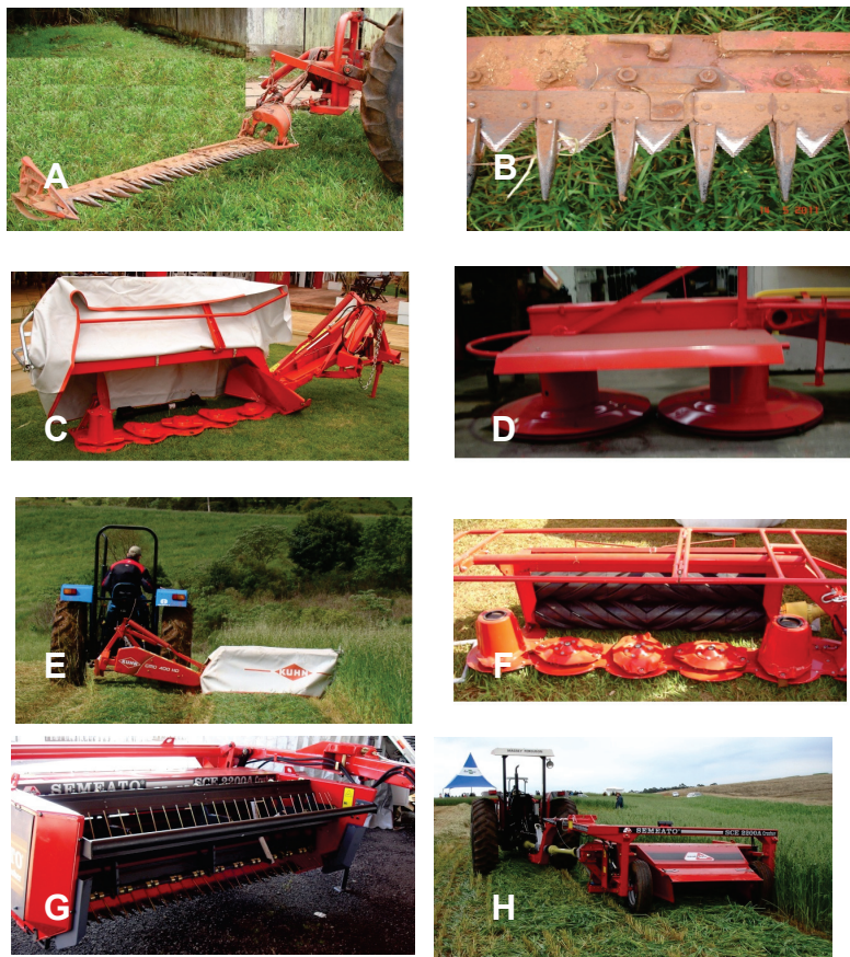
Figura 14.2 A) Segadora de barra; B) detalhe da navalha em segadora de barra; C) segadora rotativa de discos; D) segadora rotativa de tambores; E) segadora rotativa em operação; F) segadora-condicionadora de discos - detalhe dos discos e dos rolos condicionadores; G) segadora-condicionadora de barra - detalhe do molinete e da barra de corte; H) segadora-condicionadora em operação.
