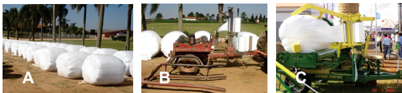
Figura 14.6 A) Fardos cilíndricos armazenados a campo; B) detalhes de uma empacotadora de fardos; C) empacotadora de fardos em ação.
