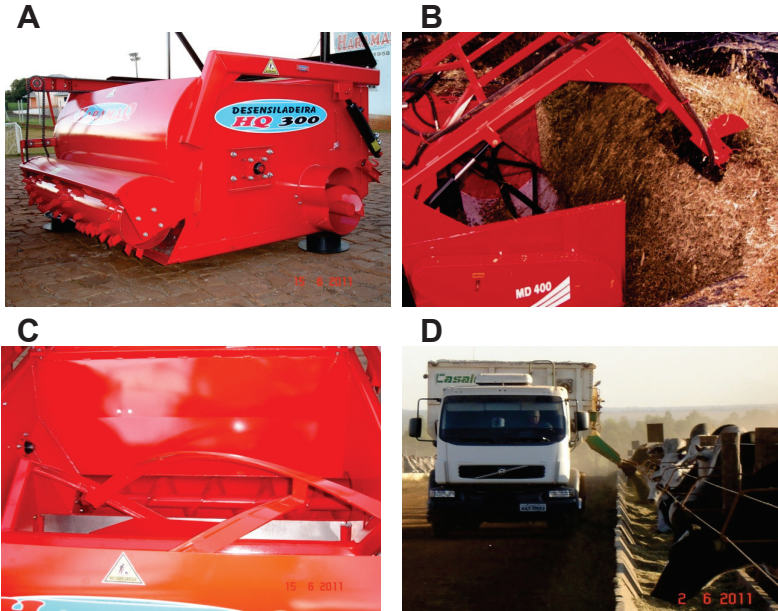
Figura 14.14 A) Desensiladora/distribuidora de silagem para montagem em trator; B) desensiladora em ação; C) detalhe da câmara e dos mecanismos misturadores; D) misturadora/distribuidora de ração montada em caminhão, em operação
