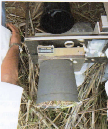
Figura 9. Amostra sendo pesada.
