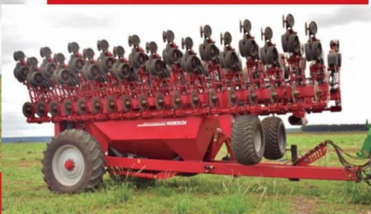
A semeadora leva um minuto e 17 segundos para alternar da posição de trabalho para posição de transporte
