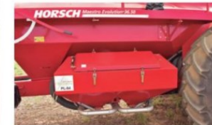
Tanque auxiliar de 600 litros pode servir para incorporação de fertilizantes microgranulados ou sementes miúdas
