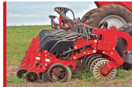
Detalhe da linha de plantio, composta por disco de corte de palha de 20 polegadas, par de discos para abertura do sulco e deposição de sementes, rodas de controle de profundidade e, por fim, roda condicionadora de sulco
