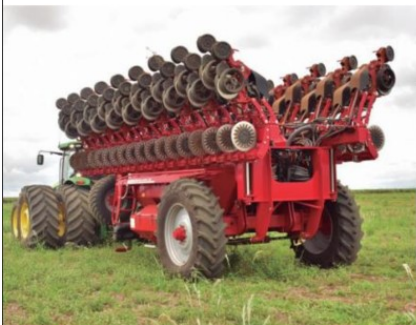
A semeadora leva um minuto e 17 segundos para alternar da posição de trabalho para posição de transporte
