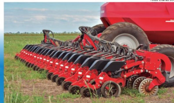
A semeadora utilizada no test drive tinha 36 linhas de plantio com 50cm de espaçamento
