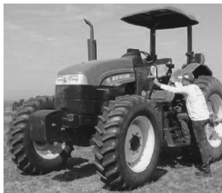
Figura 1 – Acesso através de degrau e corrimãos assegurando 3 pontos de apoio.
