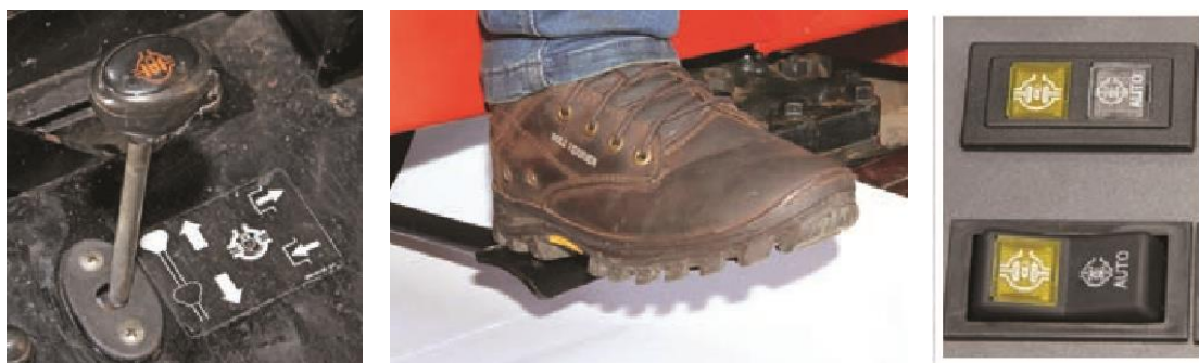
Figura 15 – Na esquerda alavanca e no centro pedal para acionamento do diferencial de forma mecânica, à direita acionamento eletro-hidráulico através de botão, neste modelo há inclusive a opção de que o acoplamento ocorra de modo automático.
