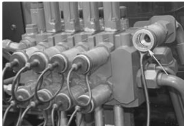
Figura 21 – Trator com cinco conjuntos de VCR e à direita, indicada pela seta, conexão de espera de retorno livre, utilizada em equipamentos que possuem motor hidráulico acionado pelo trator.
