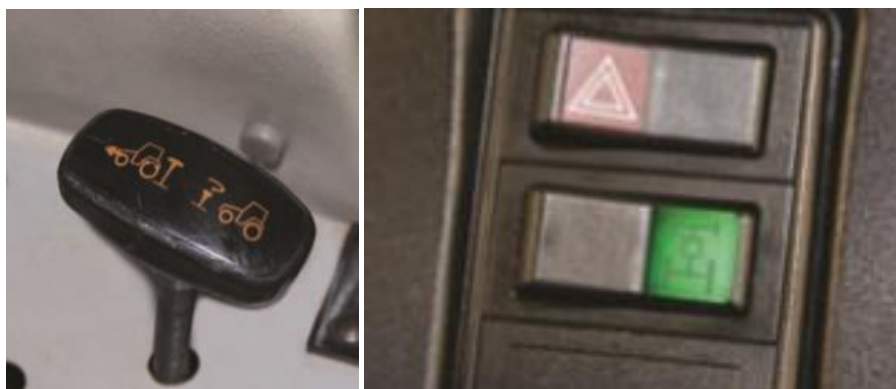
Figura 16 – Na esquerda exemplo de alavanca para o acionamento mecânico da TDA e na direita botão para acionamento eletro-hidráulico.
