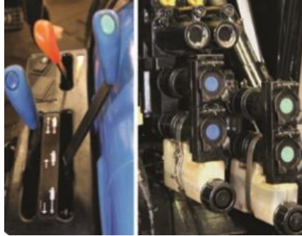
Figura 20 – Alavancas de controle das VCR codificadas em cores e à direita as VCRs com codificação correspondente às alavancas.
