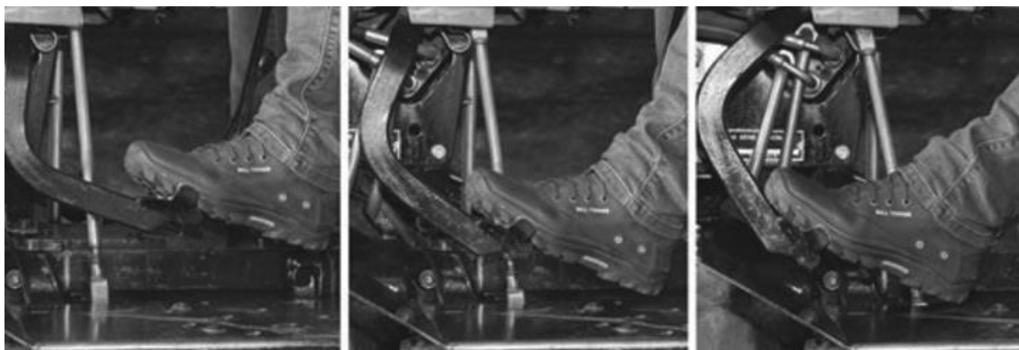
Figura 12 – Acionamento por pedal com dois estágios. Na esquerda posição inicial, ao centro primeiro estágio e à esquerda segundo estágio.
