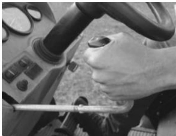
Figura 11 – Acionamento por dois mecanismos, composto por um pedal que interrompe o rodado e uma alavanca manual que interrompe a TDP. É possível parar o trator sem parar a TDP e parar a TDP sem parar o trator.
