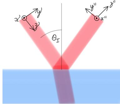
a) Se o índice de refração no meio incidente é  $n = \sqrt{3}$ , qual o ângulo de Brewster ( $\theta_B$ ) para o qual a reflexão é linearmente polarizada?
