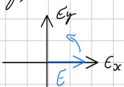
Visto do eixo  $z$  para a origem, temos o campo  $\vec{E}$  girando no sentido anti-horário; polarização circular direita.
