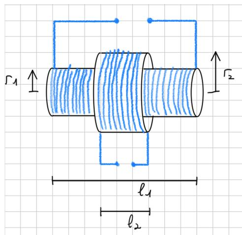
a) Ao circular uma corrente  $I_1(t) = I_1 \cos(\omega t)$  pelo indutor  $L_1$ , qual a força eletromotriz  $\mathcal{E}_\in$  gerada nos terminais do indutor 2?
