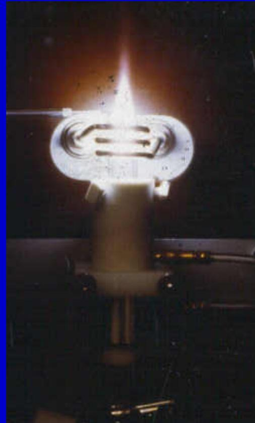
Fonte de plasma induzido. Na qual, I representa a corrente fornecida pela fonte de radiofrequência e H a linha do campo magnético oscilante induzido (Esteban<sup>[ii]</sup>).
