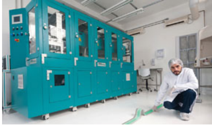
A máquina de impressão e produção das fitas em rolo
