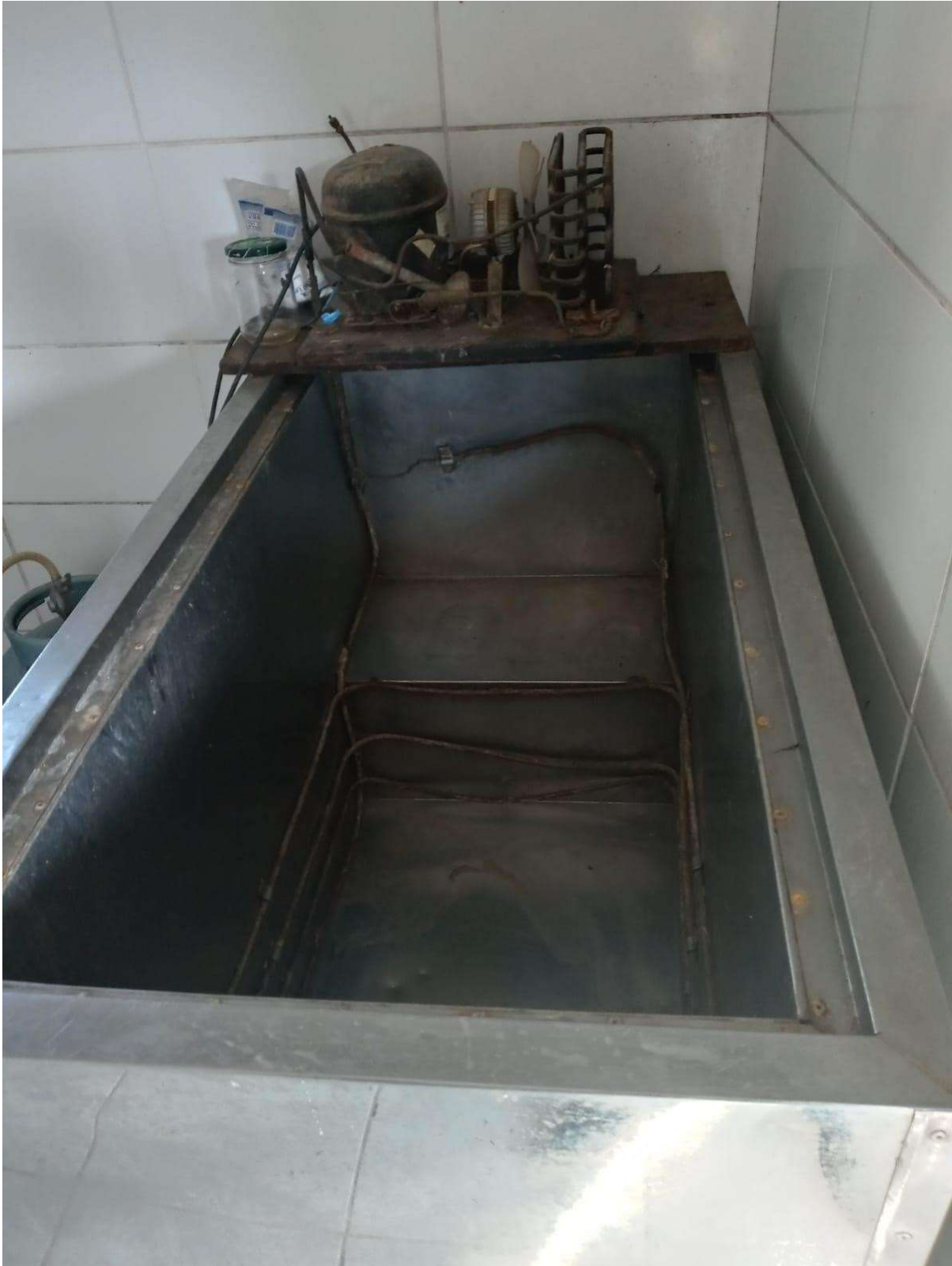
Foto 13 – Equipamento (freezer) usado para armazenar água fria onde as carcaças eram depositadas após serem evisceradas, com sujidades, não apropriado para essa finalidade.
