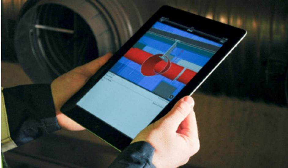
Figura 36: Tela do app Tekla Field 3D, consultando informação de coordenação de modelo BIM. Fonte: Trimble.
