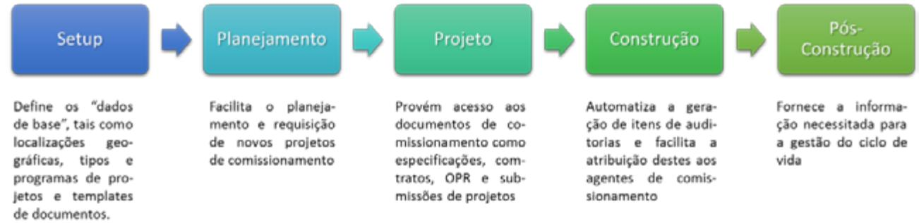
Figura 44 – Diagrama de fluxo para execução de comissionamento. Fonte ARCHIBUS
