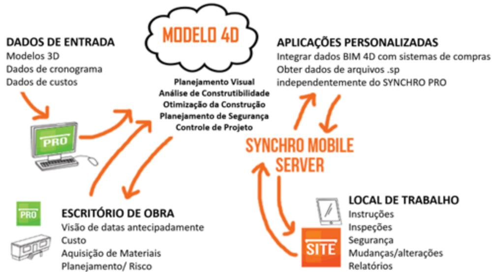
Figura 16: Diagrama de relacionamento entre processos de gestão e os módulos da solução Synchro. Fonte: adaptado de SYNCHRO LTD
