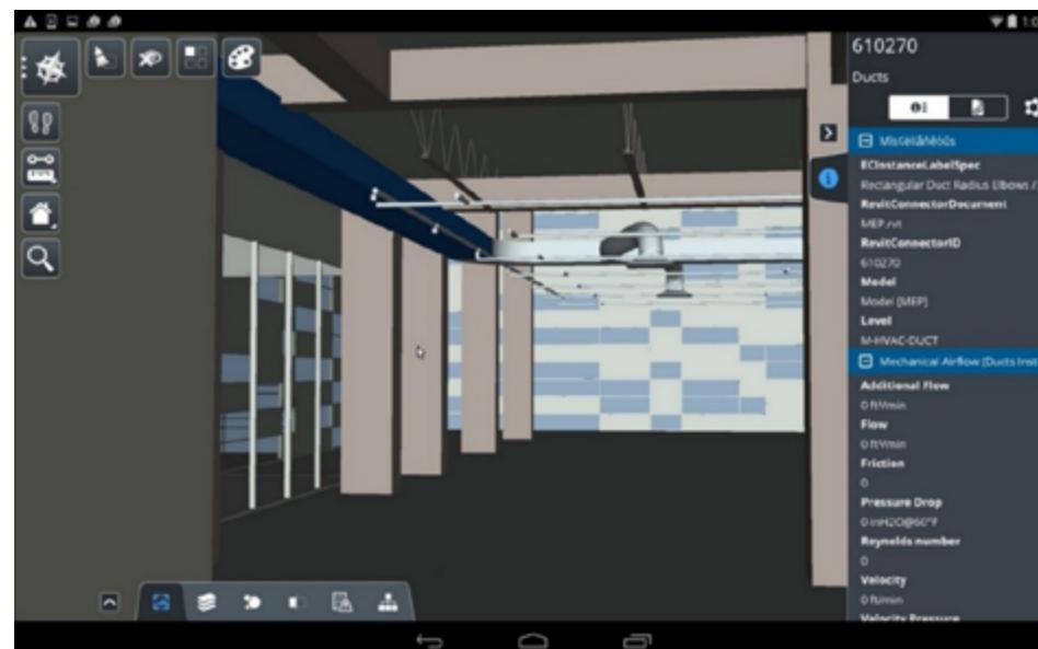
Figura 33: Tela do app Bentley Navigator, realizando navegação em modelo BIM. Fonte: Bentley.
