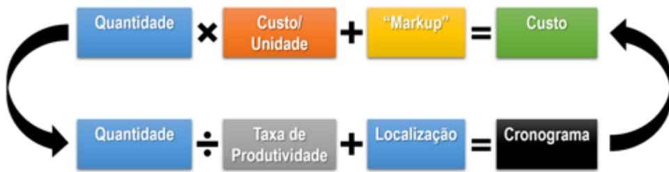
Fig. 24 – Método de cálculo para Custos e Cronograma considerados pelo Vico Office. Fonte: adaptado de Trimble.
