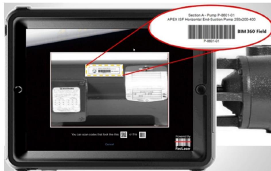
Figura 40: Exemplo de captura de dados em campo utilizando código de barras no BIM 360 Field. Fonte: Autodesk
