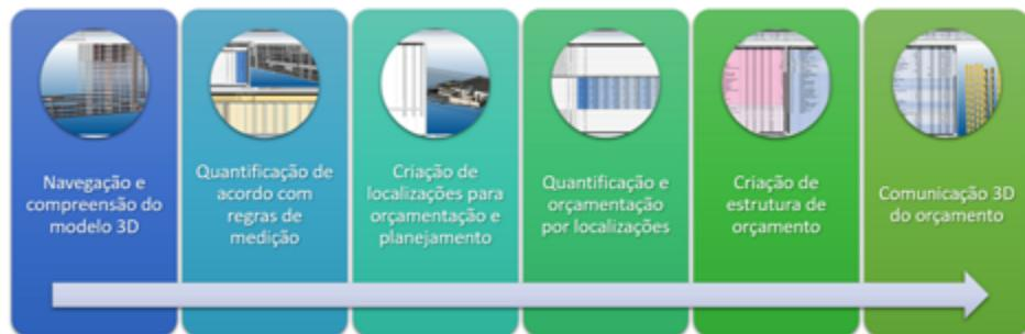
Figura 25 – Fluxo de trabalho para desenvolvimento de orçamentação sugerida no Vico Office. Fonte: adaptado de Trimble.
