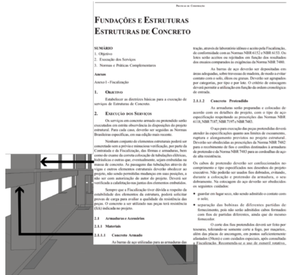
Figura 40: Vínculo entre elementos de estrutura de concreto e texto sobre o elemento para Caderno de Encargos. Fonte: GDP
