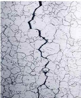
CST intergranular de uma tubulação de liga 600 em água de serviço ácida contendo H<sub>2</sub>S
