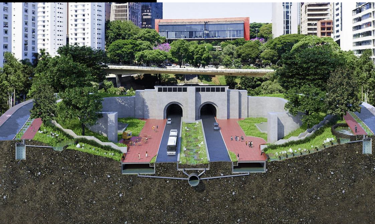
Visão geral com uma seção de infiltração da praça da Saracura.(foto: Delfim Martins). Fonte: Caderno de bacia hidrográfica - bacia do córrego Anhangabaú. P. 192-3. FCTH + SIURB, 2021
