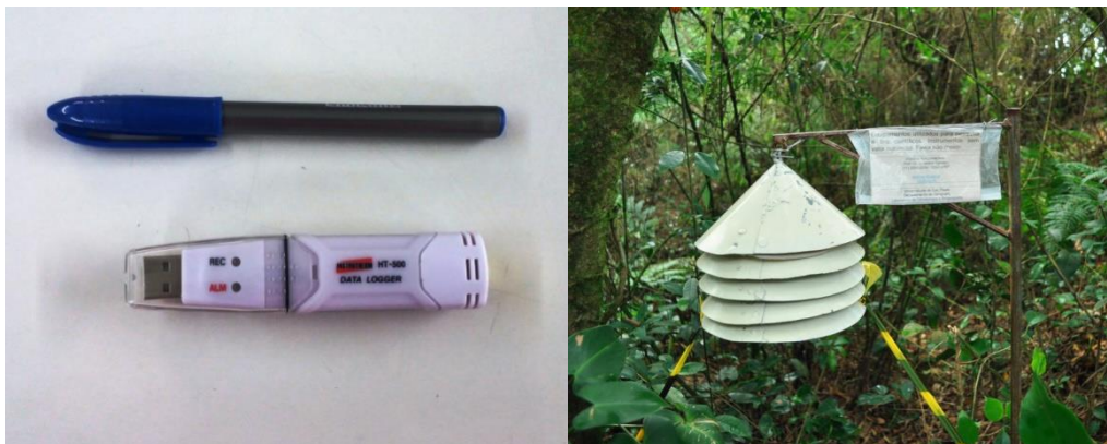
Figura 3: Sensor digital (datalogger) e abrigo meteorológico instalado no ponto P8. Fonte: os autores.
