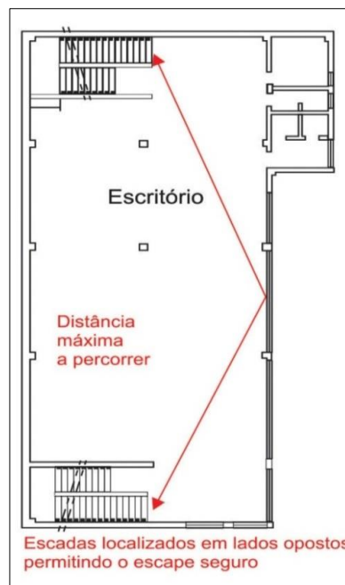
Figura 37: Localização e caminhamento para acesso a uma escada.
