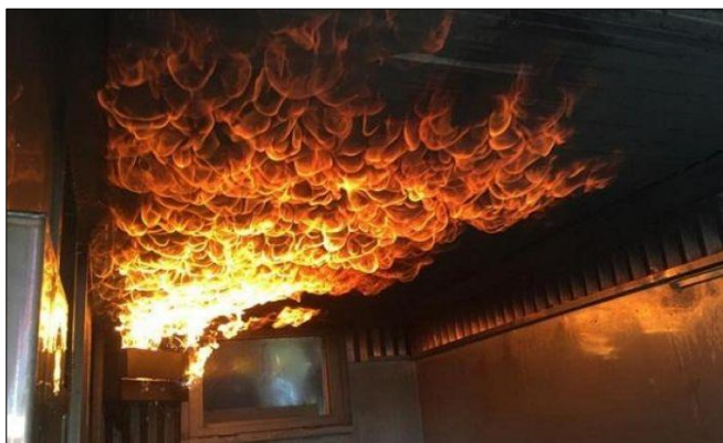
Figura 18: Fase anterior ao “ flash over ” – grande desenvolvimento de fumaça e gases, acumulando-se no nível do teto (Fonte: rede mundial de computadores).
