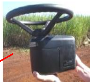
Atuador de um Piloto Automático Elétrico na Coluna de Direção
