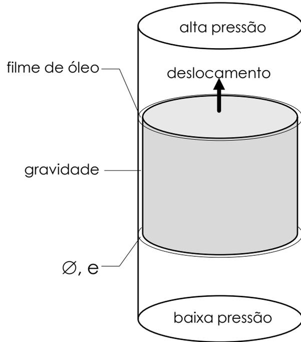
$\varnothing \gg e \rightarrow$  escoamento entre placas planas
