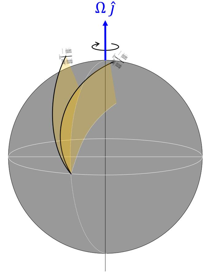
$$R_o = \frac{U}{2 \Omega R \sin(\varphi)} = \frac{\text{efeitos de inércia}}{\text{efeitos da rotação}}$$
