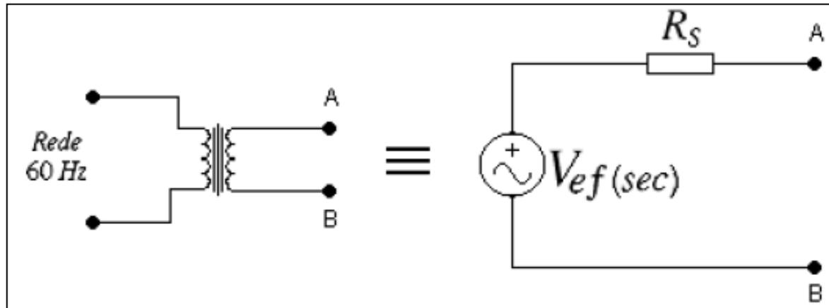
**Circuito equivalente simplificado de um trafo usado em conversores AC/DC de 60 Hz.**
