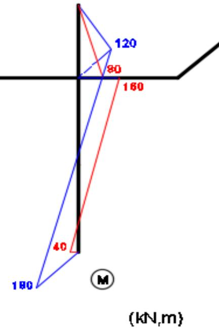
1ª. Questão: Determinar os diagramas dos esforços solicitantes no trecho BC da estrutura espacial ABCD da figura. As barras AB, BC e CD são ortogonais entre si e estão na direção dos eixos. As forças ativas (aplicadas na direção dos eixos) são a força distribuída uniformemente variada de 0 a 2 kN/m em BC e as forças concentradas aplicadas na extremidade livre D. Considere os observadores em frente aos eixos.
