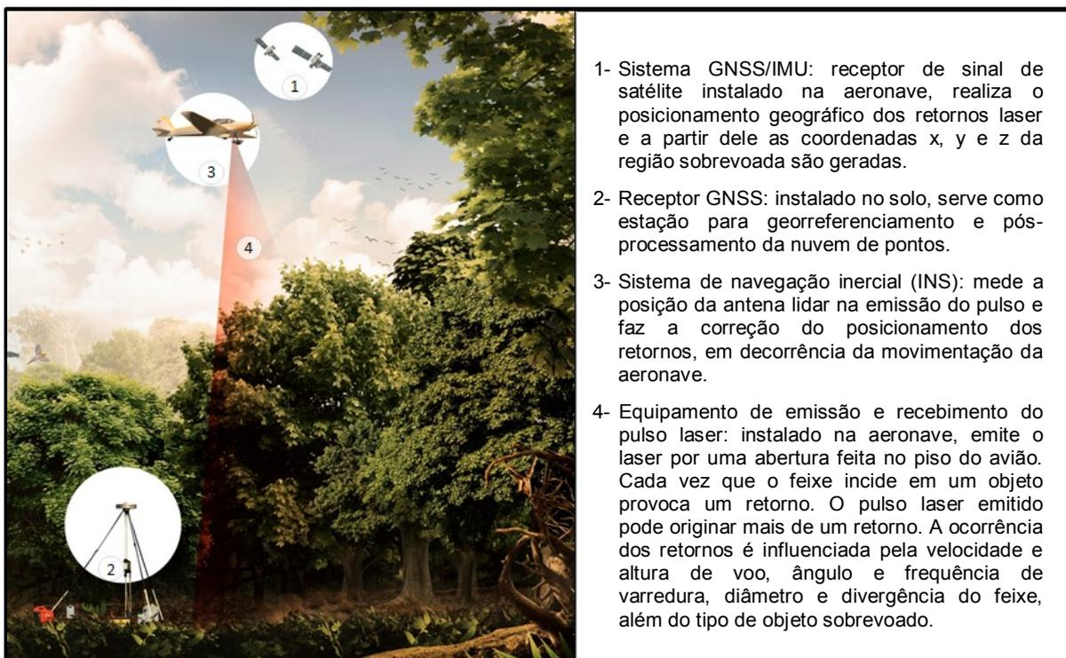
**Figura 5.** Ilustração sobre o funcionamento e equipamentos usados no escaneamento a laser aerotransportado – ALS (*Aerial Laser Scanning*) (PAPA, et al., 2017).
