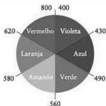
FIGURA 4 A cor percebida de um complexo, sob luz branca, é a cor complementar da luz que ele absorve. Nesta roda de cores, as cores complementares estão em posições opostas. Os números representam comprimentos de onda aproximados, em nanômetros.
