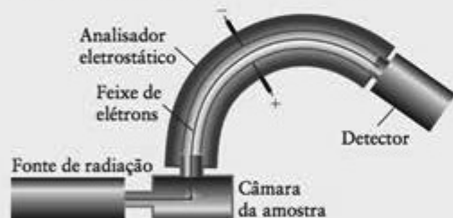
Diagrama de um espectrômetro fotoeletrônico.
