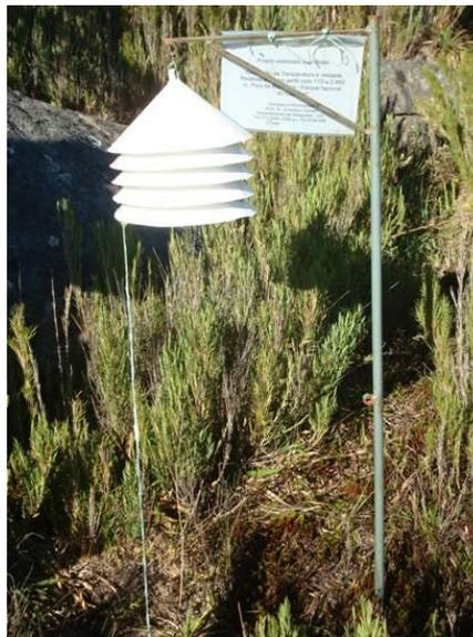
Figura 1: Mini abrigo meteorológico instalado no ponto 5 ao longo do perfil topoclimático do Pico da Bandeira, MG.
