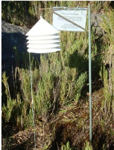
Figura 1: Mini abrigo meteorológico instalado ao longo do perfil topoclimático do Pico da Bandeira – Parque Nacional Caparaó /MG.
