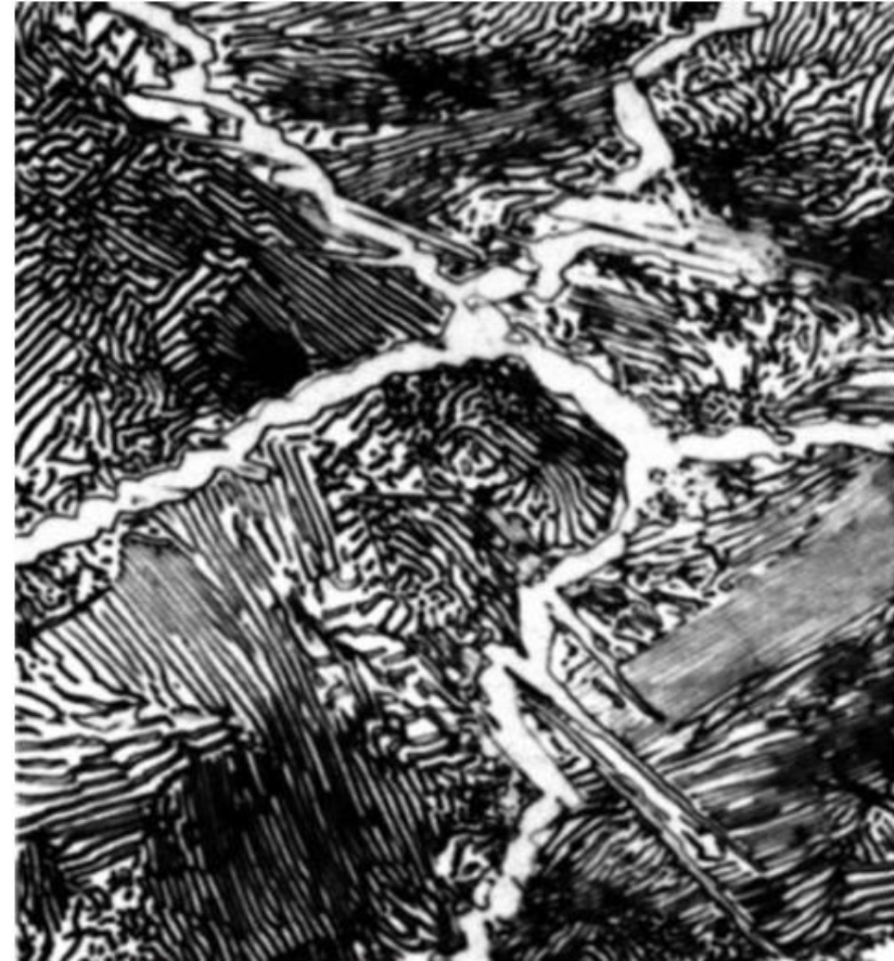
Aço hiper-eutetóide com 1.40 wt% C, composto por cementita pro-eutetóide (fase clara) e perlita. 1000x.
