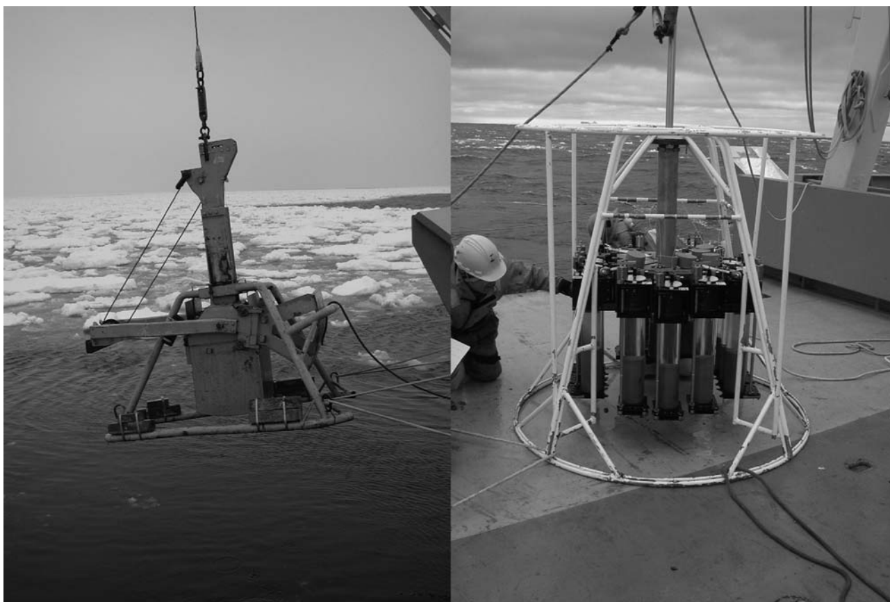
Figura 16.3 O box corer (esquerda) e o megacorer (direita) são equipamentos fundamentais no estudo da fauna de mar profundo. Cortesia do Projeto FOODBANCS.
