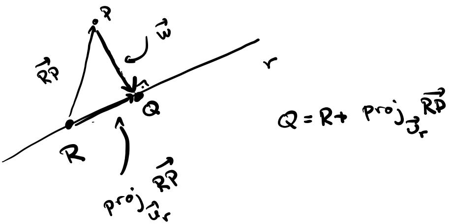
$$\vec{RP} + \vec{w} = \text{Proj}_{\hat{u}_r} \vec{RP} \Rightarrow \vec{w} = \text{Proj}_{\hat{u}_r} \vec{RP} - \vec{RP}$$
