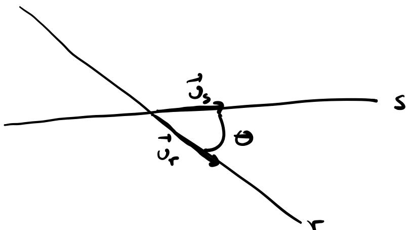
Def:  $\theta = \min$  ângulo entre  $\vec{v}_r, \vec{v}_s$  ou  $\vec{v}_r, -\vec{v}_s$
