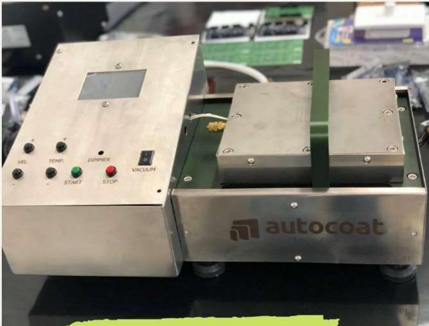
Equipamento de blade coating para deposição de filmes finos modelo BCC-01
