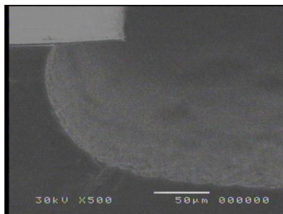
Figura 4.25. Condições de Processo: 23SF 6 /120Ar, 42 mTorr, 525 W ICP , 30 min., T el =20 °C, \alpha = 90^\circ ; C L ~62 \mu\text{m} ; C V ~137 \mu\text{m} ; TC Si =4,7 \mu\text{m}/\text{min} .
