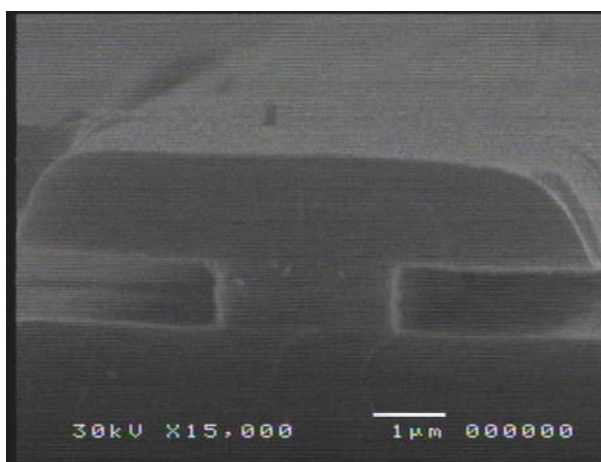
Figura 4.5. Imagem SEM do perfil de Si-poli após corrosão. Condições de Processo: SF_6/CF_4/CHF_3 = 3/10/4 sccm, 150 mTorr, 50 W, 72 V, 8,5 min, ULE=2,8 µm, LLE=2,8 µm, A_t=0,98 , S \sim 40 .
