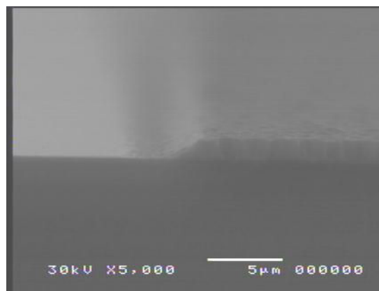
Figura 4.47. Imagem SEM da máscara de Ni com tratamento térmico após corrosão úmida e antes da corrosão por ICP. Th_{Ni} = 1,5 \mu\text{m} .
