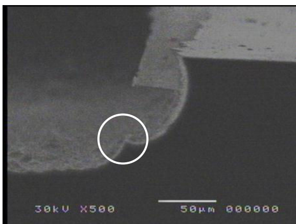
Figura 4.23. Condições de Processo: 13SF 6 /120Ar, 40 mTorr, 525 W ICP , 30 min., T el =20 °C, \alpha = 90^\circ ; C L ~48 \mu\text{m} ; C V ~110 \mu\text{m} ; TC Si =3,7 \mu\text{m}/\text{min} .
