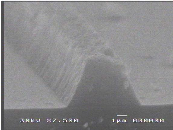
**Figura 4.31.** Imagem SEM do perfil da corrosão de Si-poli localizado no centro do eletrodo em plasma de  $SF_6/CF_4/N_2$ . Condições do processo: 10/15/20 sccm, 150mTorr, 50W, ~90V, TC=245nm/min, S=18, 17,5min.
