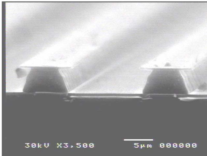
Figura 4.7. Imagem SEM do perfil de si-poli após corrosão em plasma de SF<sub>6</sub>/CF<sub>4</sub>/N<sub>2</sub>. Condições do processo: 2/3/4, fluxo total de 45 sccm, 150mTorr, 50W, 74V, 15min, TC=273nm/min, S=26.
