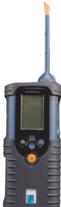
Figura 33.9 O Cyrano 320. O nariz eletrônico pode ter aplicação na indústria alimentar, na criação de animais, em casos legais e na medicina. [Cortesia de Cyrano Sciences].
