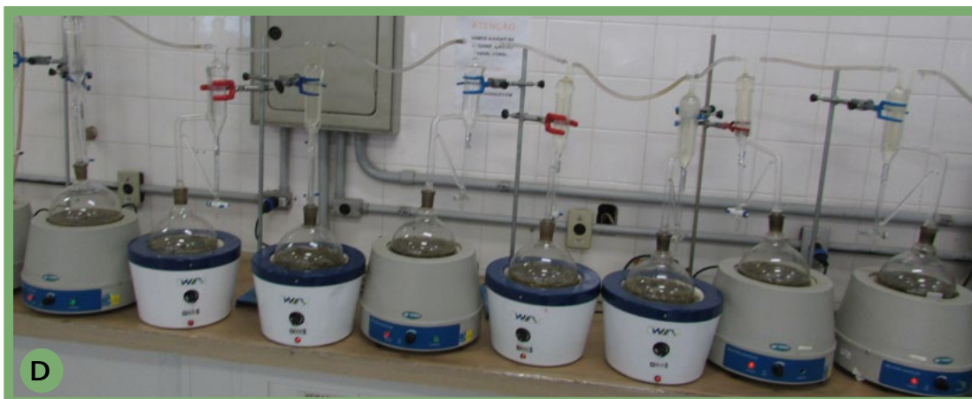
Figura 1: Coleta e extração de óleo essencial de folhas e cascas de Drimys brasiliensis , no município de Curitiba-PR: D. Extração do óleo essencial de folhas e cascas em equipamento tipo Clevenger. Fonte: MAGGIONI (2017)
