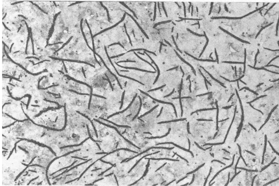
Fig. 18 (a) - Ferro fundido cinzento per- lítico. Perlita fina e gra- fita tipo A. CE = 3,8. Ata- que Nital. Aumento 100 x. Ampliação 1,5 x.
